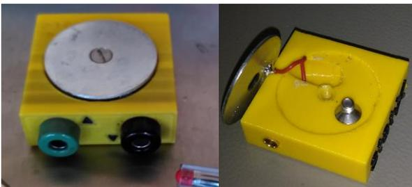
Abbildung 6 und 7: Elektrode mit 2 Seiten und Konstruktion der einseitigen Elektrode.
