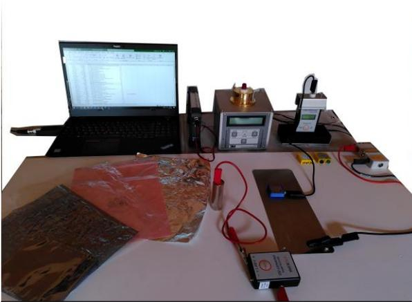
Abbildung 4: Messaufbau mit unterschiedlichen Voltmetern, Elektroden und Beuteltypen.
