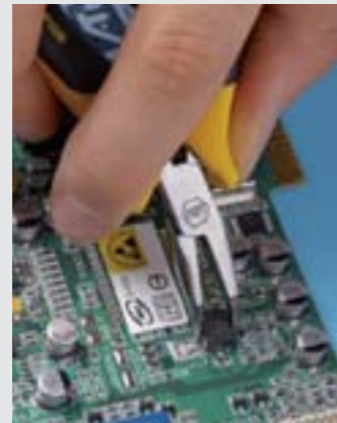
Die Flachrundzange Professional ESD wird vorwiegend für feine Greif- und Biegearbeiten eingesetzt.
