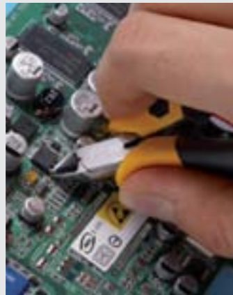
Der Seitenschneider Professional ESD mit breitem, spitzem Kopf schneidet weiche Drähte flach und bündig.
